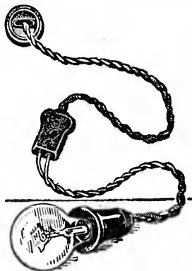
Рис. 93. Проверка шнура контрольной лампой.
