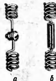
Рис. 91. Способы соединения концов перегоревшей нагревательной спирали прибора.
